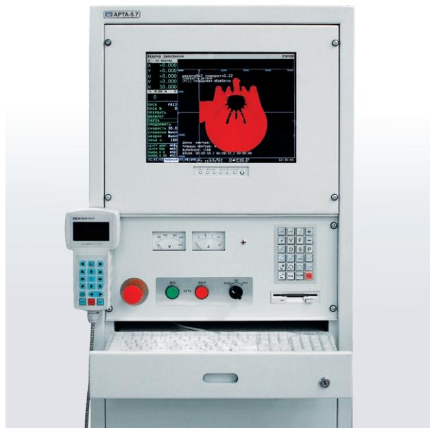
За счет интерполяции (шага) рабочих перемещений координатных осей станка с **дискретностью 0,01...0,1 мкм** достигается высокая равномерность процесса обработки, улучшенные показатели точности и чистоты изготавливаемых деталей.
