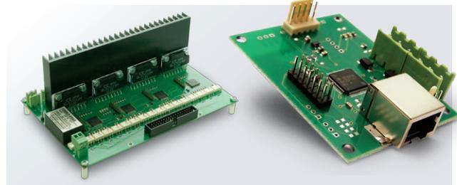
**Новый генератор** технологического тока **АРТА-5М** (см. спецификацию конкретной модели станка) с архитектурой, обеспечивающей непосредственную коммутацию источника питания с искровым промежутком (без LC-цепочек). За счет реализации максимально коротких импульсов высокой амплитуды обеспечивается повышенная производительность и чистота поверхности обрабатываемых деталей.
