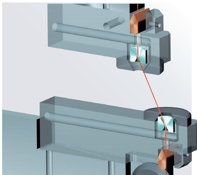
Ряд моделей станков **APTA** может быть оснащен дополнительными элементами для возможности обработки **специальными тонкими проволоками** (диаметром от 0,01мм=10мкм), что позволяет изготовление микро-деталей с шириной паза менее 20мкм.
